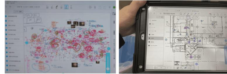
ベースレイヤー、機器取付レイヤー、機器取付済レイヤー、図面修正レイヤーなど、必要最小限のレイヤーを設定したテンプレートに、必要なレイヤーを追加して作成する。
